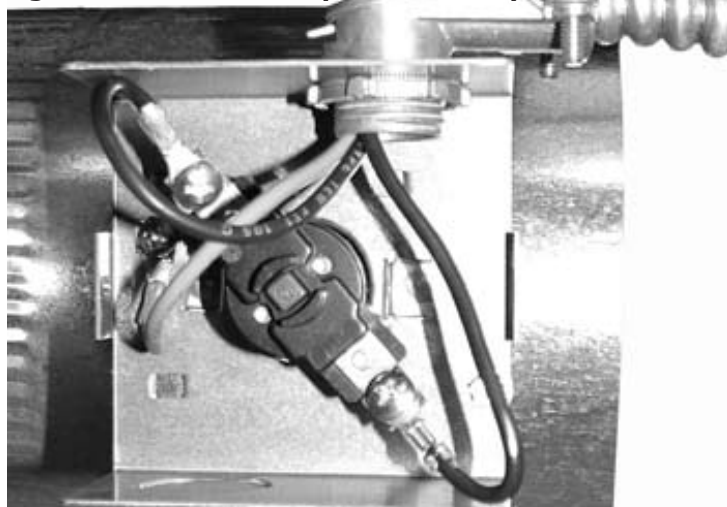
Figure 2 – Circuit électrique de l'interrupteur de sécurité
