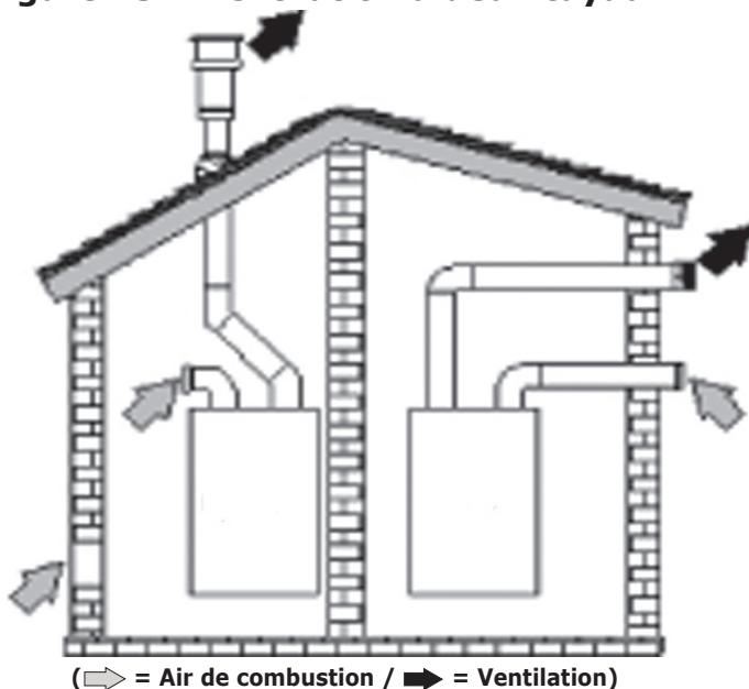
Figure 13 - Ventilation à deux tuyaux
