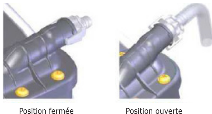
FIGURE 9-5 Soupape d'évacuation mécanique, sommet de l'échangeur thermique
