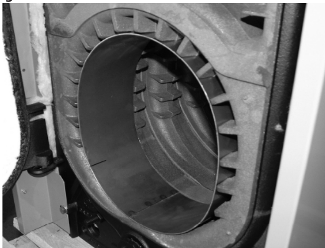
Figure 12 - Chemise en V
